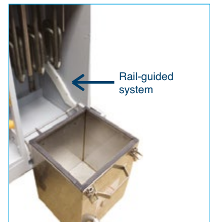
Geleid tank naar beneden via rail system
